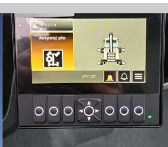
Talpalás visszajelzés és PTO jelzés a kabinban
